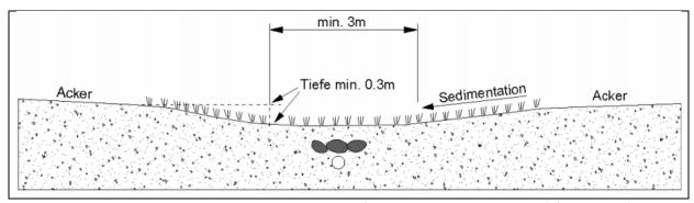
Abb. 5 Schematische Darstellung einer begrünten Abflussbahn, entnommen aus (LfULG, 2010)
